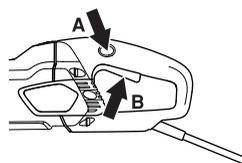
Фиксаторът на прекъсвача остава отпуснат, докато е отпуснат и прекъсвачът. Когато захватът на дръжката бъде пуснат, както прекъсвачът, така и неговият фиксатор се рестартират. Това се осъществява с помощта на две независими една от друга възвратни пружини. При тази позиция машината спира и прекъсвачът се заключва.
